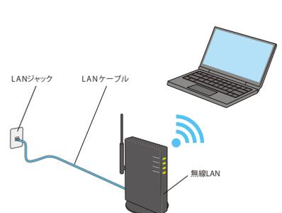
設置されているLANケーブル差込口にLANケーブルを差し、無線LANと直繋ぎにします。
