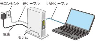
モデムには電源・光コンセント・LANケーブルを配線し、LANケーブルでモデムとPCを直繋ぎにします。
